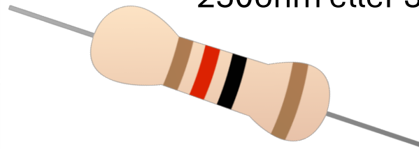
Motstand, for eksempel 250ohm eller 330ohm
